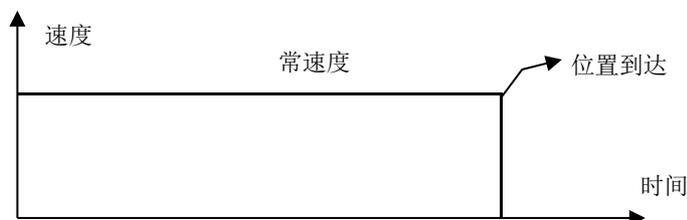
图 3-1 常速运动方式的速度曲线
